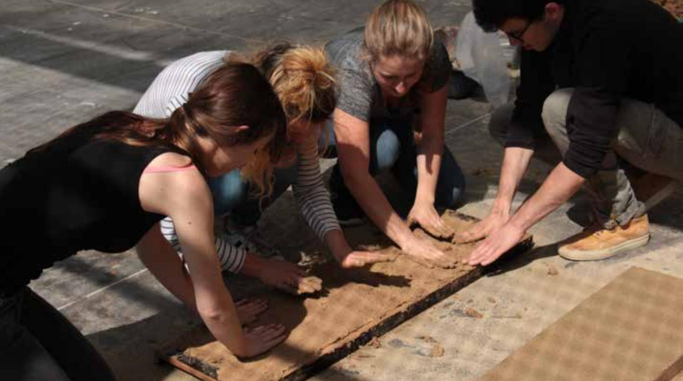
Le moulage des briques d'un mètre de long nécessite de la main d'œuvre ! Ces longues briques sont très fibrées pour éviter la fissuration.
