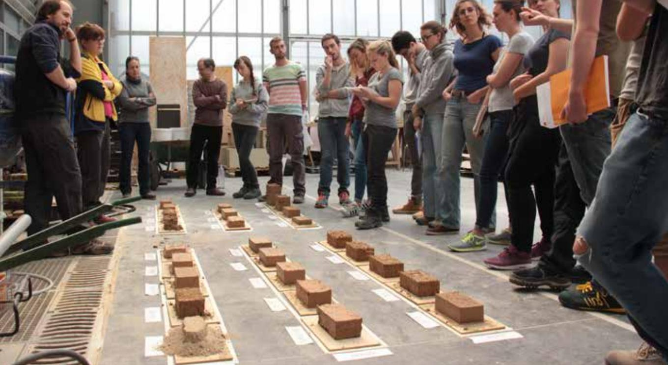
▲ Matrice permettant d'étudier les paramètres influençant la production d'une brique: grains, fibres, eau, geste, moule, forme...
