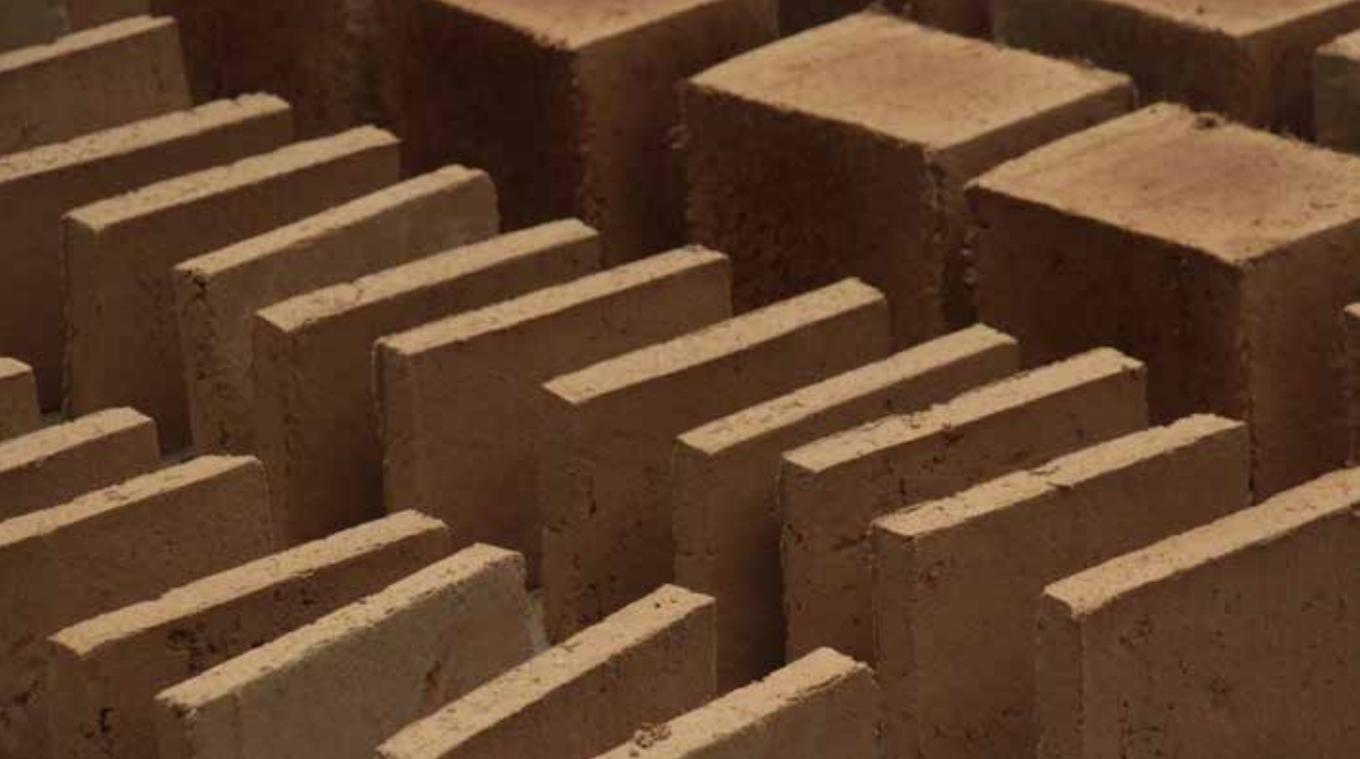
▲ Séchage à l'air libre des briques d'adobes. Dès que possible, les briques sont posées sur la tranche pour sécher uniformément.
