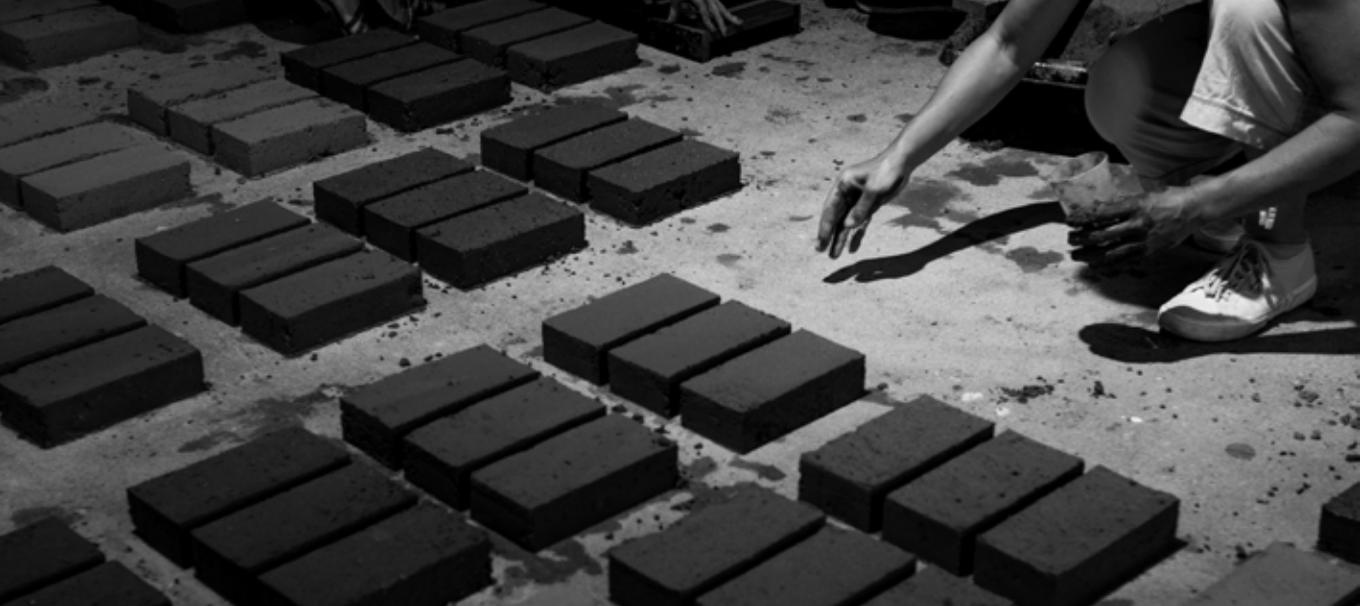
▲ Avant de mouler la brique au sol, il faut s'assurer qu'elle n'adhérera pas trop à celui-ci. Sur un sol en béton lisse comme celui de la Sucrière, il est nécessaire d'ajouter du sable fin pour mettre la brique « sur roulettes ». Cela réduit l'adhérence et limite les déformations liées au séchage différentiel.
