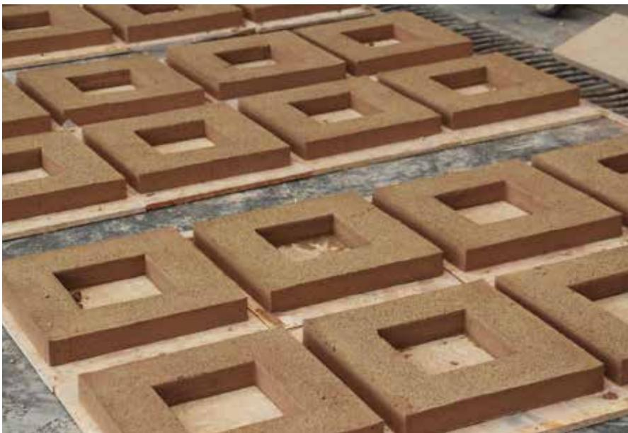
▶ Séchage des briques à l'air libre. Afin d'alléger les mobiliers, les briques ont été réalisées creuses.
