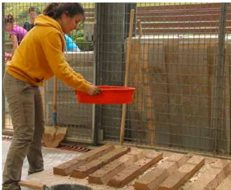
◀ Sablage des briques pour éviter un séchage trop rapide pouvant entraîner des fissurations.
