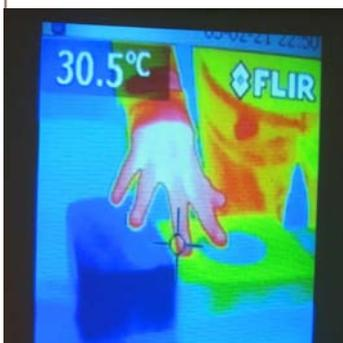
Illustration de transferts dynamiques de chaleur via l'utilisation simple d'une caméra infrarouge. Ici, la chaleur de la main est transmise, puis restituée, de manière différente en fonction des deux matériaux et de leurs conductivité et masse thermiques.
