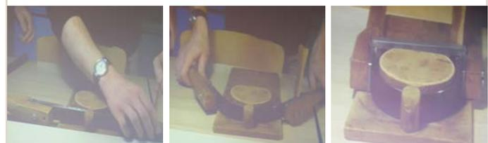
Le bois n'a pas les mêmes caractéristiques en fonction de son humidité et de sa température. Ici un bois sec est humidifié et chauffé puis cintré dans un outil de luthier. Le bois se déforme alors à la main et préférentiellement dans sa partie en compression (interne).
