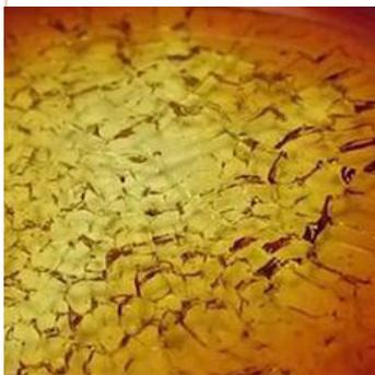
Réseau de fractures créé dans un caramel lors de l'ajout d'eau froide. Les fissures se propagent de façon à minimiser l'énergie selon un motif à angles droits caractéristique de cette matière.
