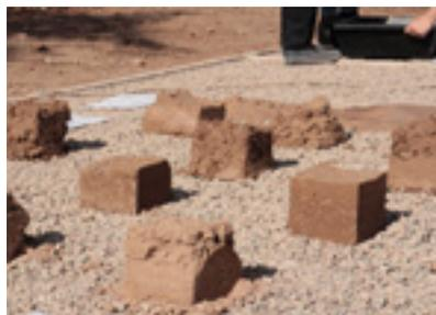
Restitution en extérieur de la matrice du test Carazas et des matrices fibres. Des matrices ont également été réalisées avec de l'argile rouge et de la terre blanche. ↓
