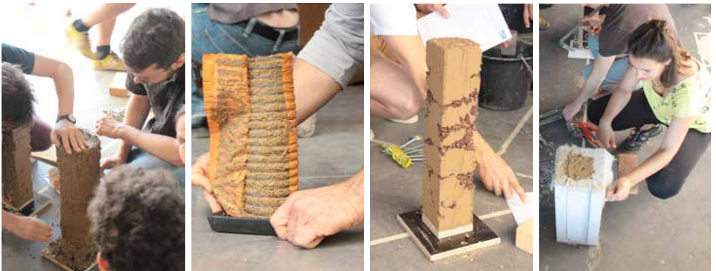
Phase de décoffrage 12h après les coulages des différents échantillons
