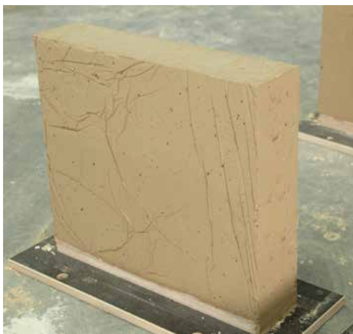
Les échantillons réalisés en terre coulée stabilisée au plâtre ont été décoffrés le lendemain matin afin d'obtenir une dureté suffisante pour laisser apparaître les détails des matrices et peaux de coffrage.
