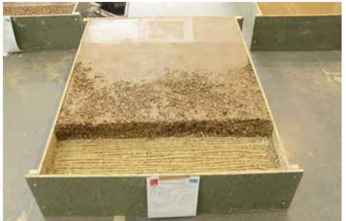
Dalle allégée (S2), avec une couche d'isolation phonique
