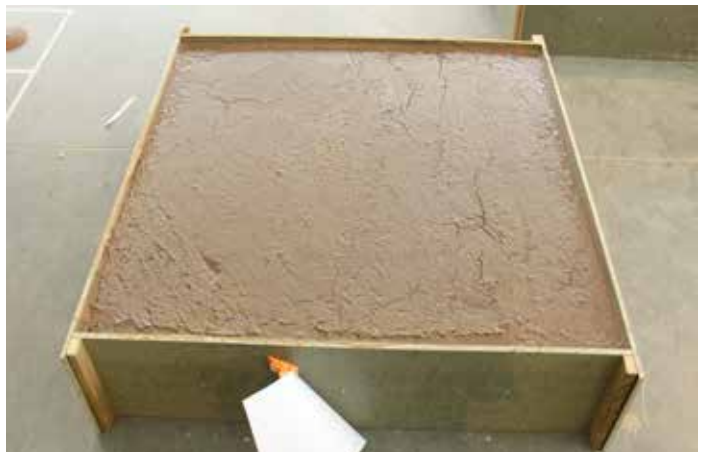
Chappe vibrée, autoplaçante (S4)
