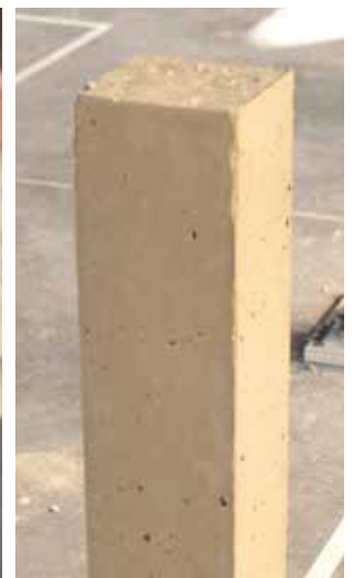
Terre stabilisée au ciment
