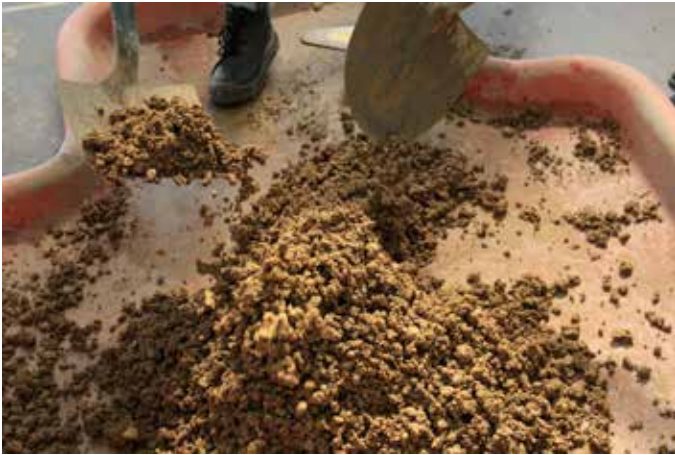
Préparation des mélanges dans des bacs à gâcher ou au malaxeur planétaire
