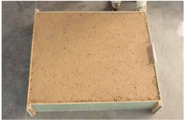
Dalle talochée monocouche (S2), finition éponge à sec
