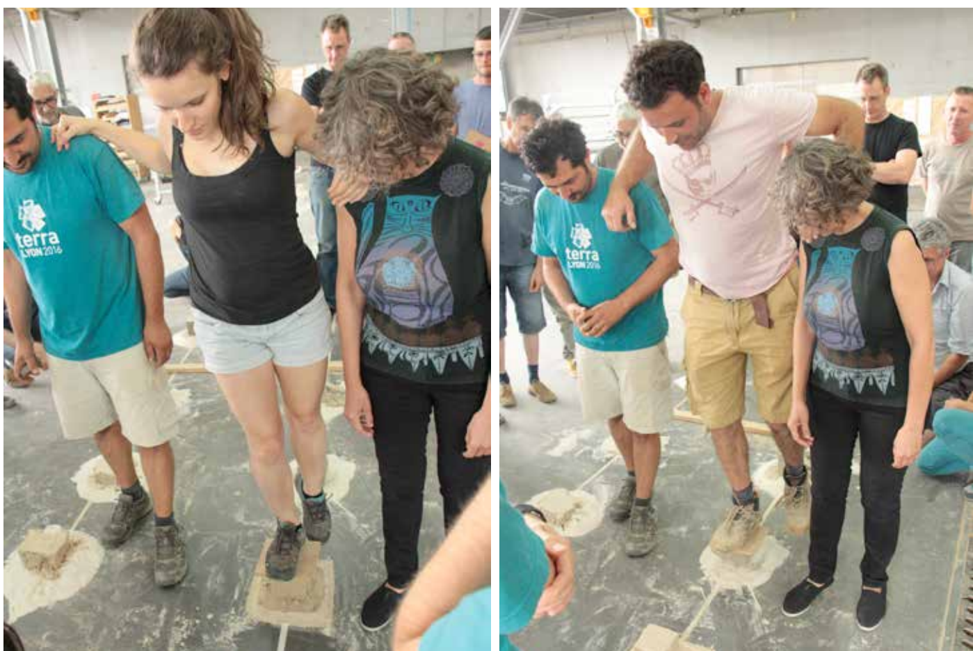
Les échantillons sont simplement testés à la compression en faisant monter différentes personnes sur une planche de répartition.
