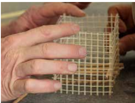
Gabion formé en cage de toile de verre
