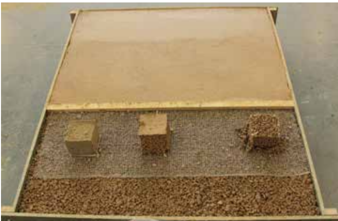
Dalle allégée avec pouzzolane + finition enduit micro-fibré
