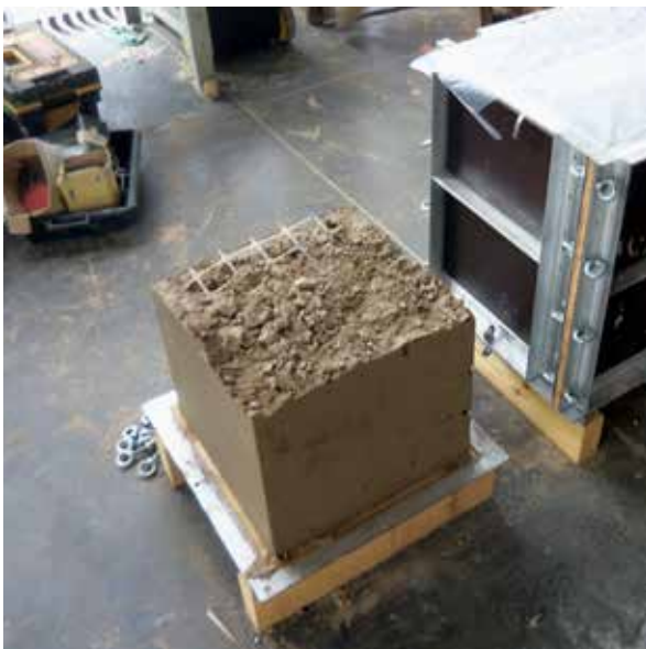
Muret bas armé : essais d'une armature avec des géogrilles positionnées à l'horizontale dans un bloc de terre coulée (festival grains d'isère 2013)
