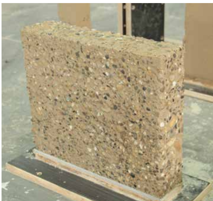
Les échantillons réalisés en terre coulée stabilisée au plâtre ont été décoffrés le lendemain matin afin d'obtenir une dureté suffisante pour laisser apparaître les détails des matrices et peaux de coffrage.
