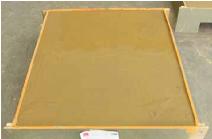
Dalle auto-plaçante (S4), composition sableuse + dispersant
