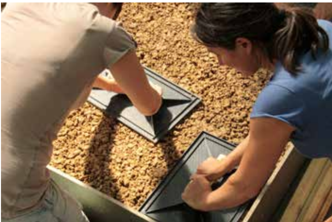
Les dalles sont talochées, lissées ou vibrées afin d'obtenir le parement souhaité.
