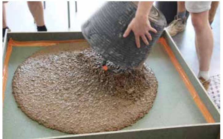
Mise en oeuvre des mélanges tirés à la règle ou simplement déversés et coulés suivant la plasticité de la composition.
