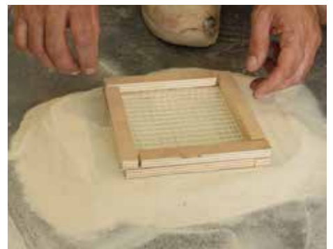
Armature horizontale en toile de verre
