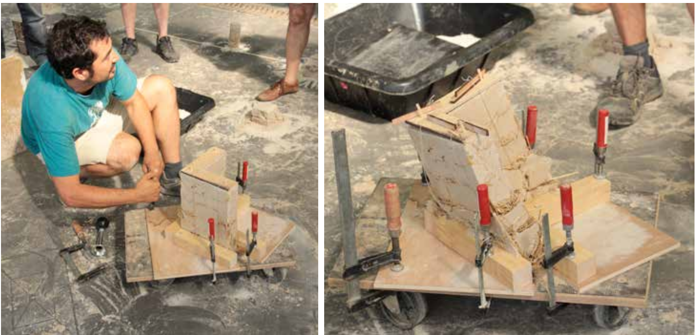
Les échantillons sont testés de manière empirique sur une table vibrante faite maison. Certains systèmes constructifs résistent davantage aux vibrations horizontales. Le meilleur échantillon est celui réalisé avec plusieurs élastiques formant un sorte de contrainte sur le sable coulé.
