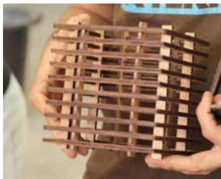
Chaînage extérieur avec des cadres bois
