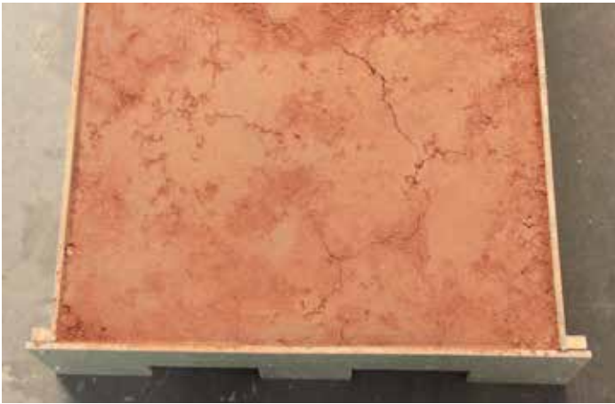
Dalle talochée (S2), mise en œuvre en 2 couches
