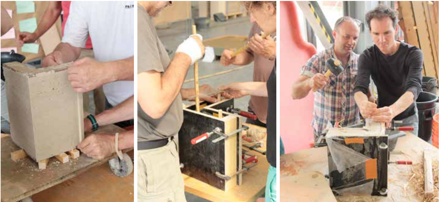
Les échantillons sont réalisés en sable coulé afin de bien enrober les armatures, certaines sont mises en place après coulage.
